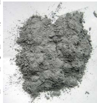
Imagem 4 – O pó de alumínio de alta pureza pode ser usado em mísseis, como elemento estrutural ou no propelente. Por isso, tem sua exportação controlada pelo MTCR e acompanhada por serviços de Inteligência.
